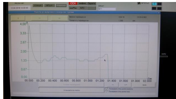
Рис. 1. Зображення кривої струму переводу стрілки в системі МПЦ-У
