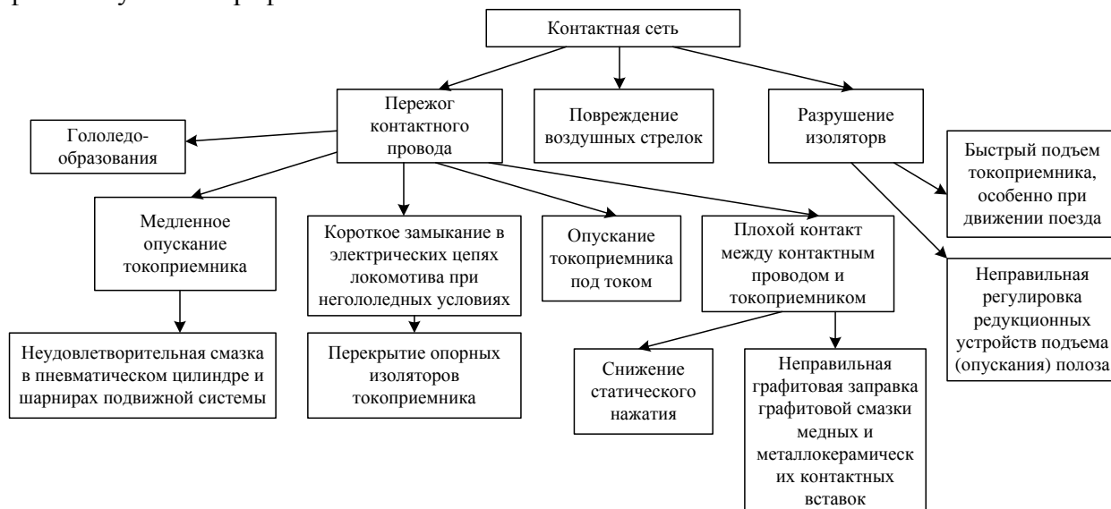
Рис. 5. Классификация и причины отказов в контактной сети
