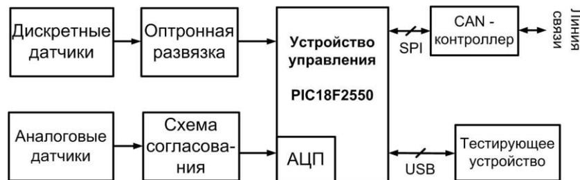
Рис. 2. Структурная схема линейного контроллера
