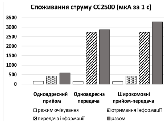
Рис.2. Дані енергоспоживання модуля CC2500 у різних режимах роботи системи
