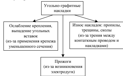
Рис. 3. Виды и причины возникновения дефектов в угольно-графитных вставках
