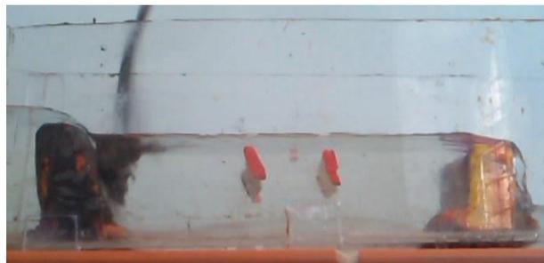
Рис. 6. Распределение примеси в отстойнике (t=0,2 с)
