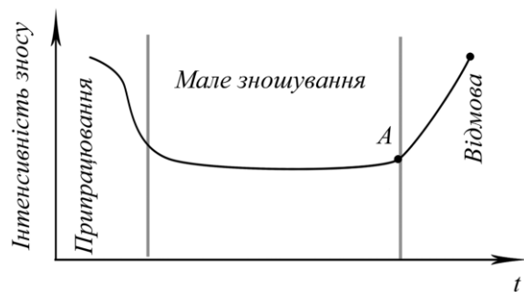
Рис. 1. Залежність інтенсивності зношування елементів реле від часу
