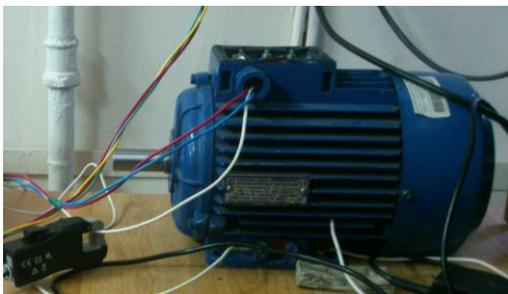
Рис. 5. Ненагруженный асинхронный двигатель типа АИРМ80А4У3. Параметры: 3Ф ~ 380 В; 50 Гц; 1,1 кВт; 1390 об/мин;  $\cos \phi = 0,81$
