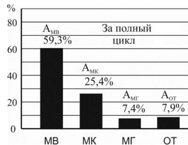
Рис. 7. Структура затрат электроэнергии на собственные нужды за цикл
