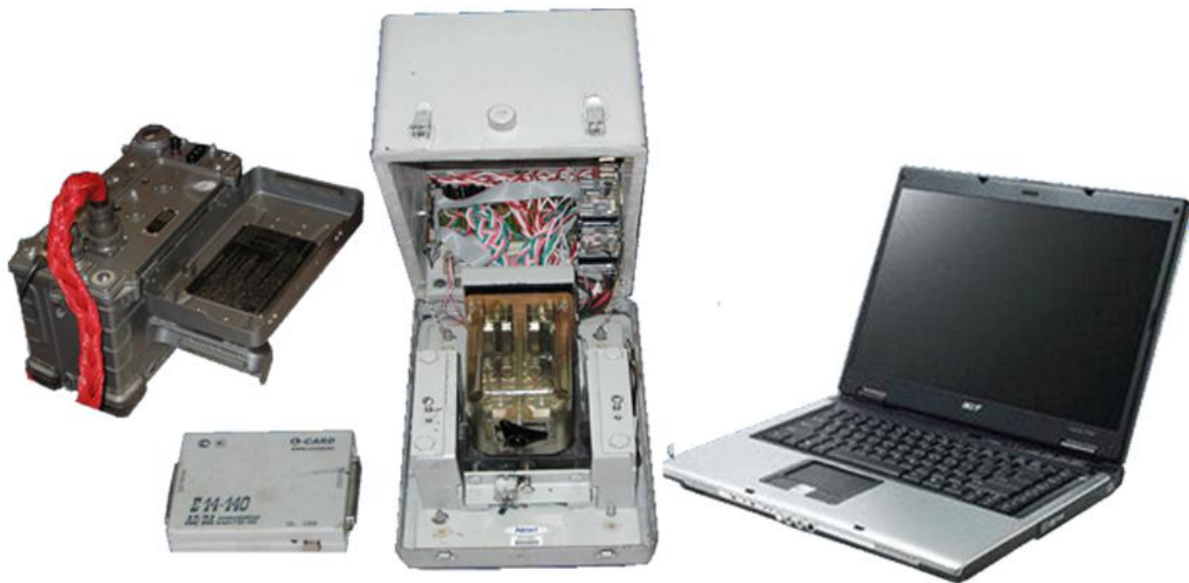
Рис. 3. Общий вид ИДК для диагностики реле железнодорожной автоматики
