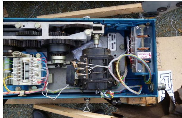
Рис. 5. Стрелочный электропривод типа УПС со снятой крышкой. Основные узлы привода
