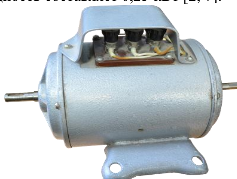
Рис. 1. Электродвигатель постоянного тока стрелочного электропривода типа МСП-0,1
