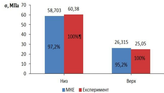
Рис. 12. Напруження в клемі 2(зн. стор. р. н) при різних методиках для локомотивів
