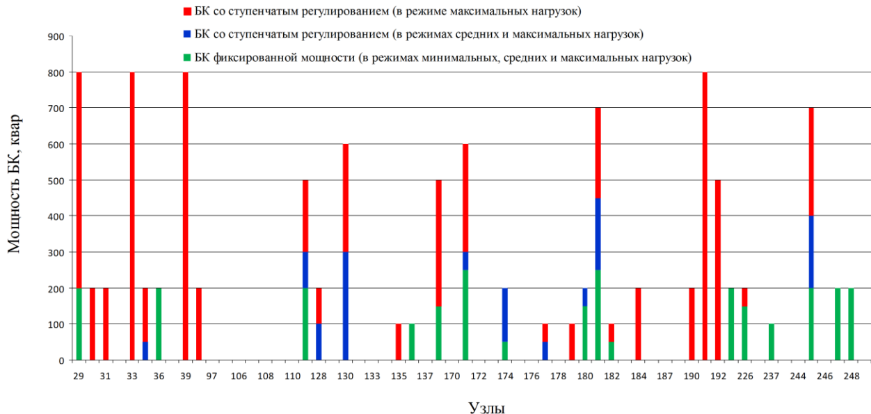
Рис. 2. Результаты выбора оптимальных мест установки и мощности БК для варианта оптимизации (д)
