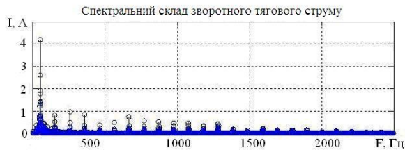
Рис. 5. Спектральний склад зворотного тягового струму при електротязі змінного струму
