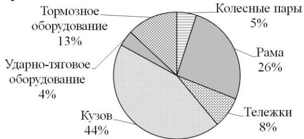
Рис. 1 Распределение повреждений грузовых вагонов за 2013–2015 гг.
