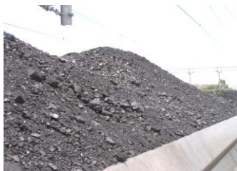
Рис. 2. «Шапка» груза превышает высоту борта полувагона [12]
